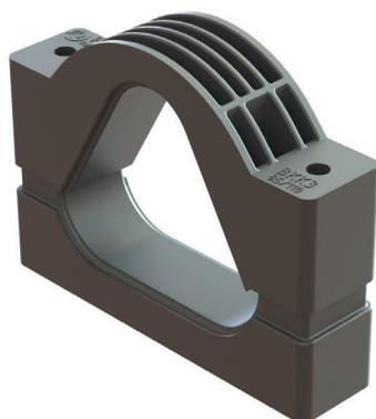
Изделие сконструировано таким образом, что при максимальных диаметрах кабеля для данного вида креплений верхняя и нижняя части находятся в постоянном зацеплении, что снижает изгибающие нагрузки на крепежный элемент и повышает тем самым общую прочность всей конструкции к механическим нагрузкам при возникновении токов КЗ\*.
