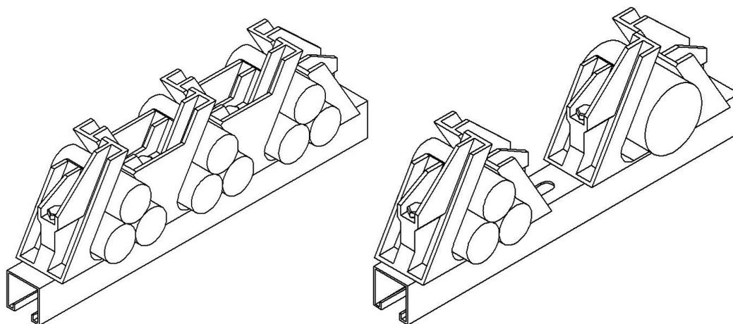
Рис.3. Пример монтажа креплений УКК-60 и УКК2-60
