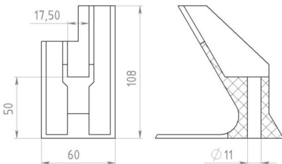
Рис.1. Внешний вид и габаритные размеры УКК-60 (мм)
