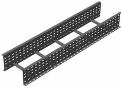
**Кабельrostы** – это металлические конструкции повышенной несущей способности. Используя кабельrost при перекрытии расстояний более 6 метров, вы получаете продукт с повышенной прочностью не за счет увеличенной толщины металла, а за счет особой формы профиля. Результат: меньше расход металла и ниже цена при высоких несущих характеристиках.
