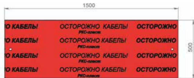
Для повышения степени защиты кабеля и удобства монтажа ЛПЗС соединяются в единую конструкцию.
